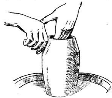
Рис. 15. Заключительная операция формовки на гончарном кругу
