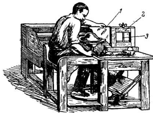
Рис. 23. Формозка плоских изделий в гипсовой форме с помощью шаблона
