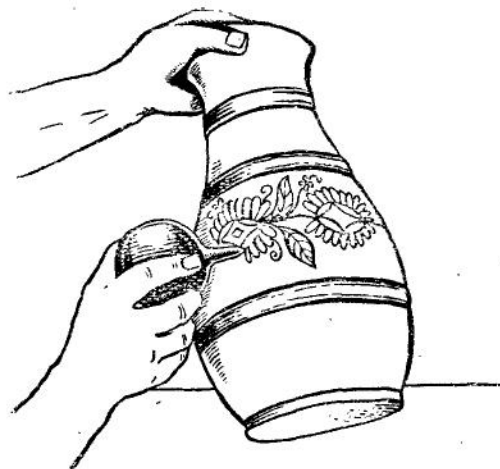
Рис. 32. Нанесение рельефа при помощи рожка
